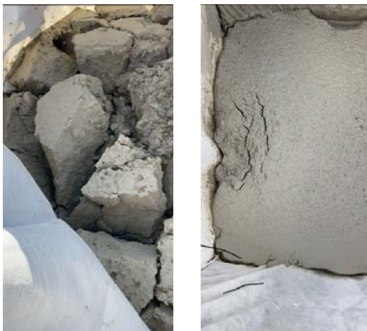
Exemple de boues déshydratées
