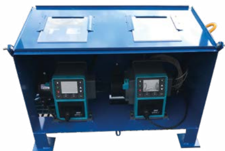
Skid de dosage
